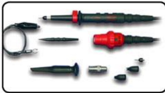
ТТ-HV250 2.5кВпк пробник
