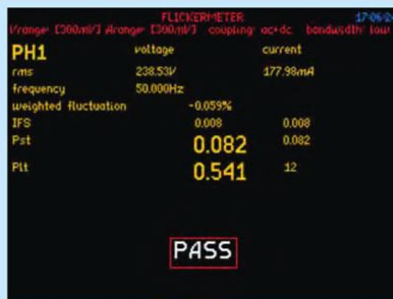
После завершения испытания на дисплее будет отображено сообщение "Годен/Не годен" (Pass/Fail). Снимок экрана может быть передан на ПК. Также испытания могут проводиться удаленно с помощью ПО.
